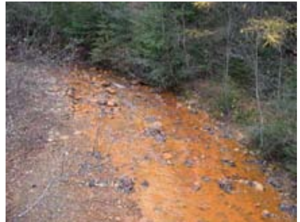
Figure 2. Exemples de DMA. Photo de gauche : Exfiltration au bas d'une halde de stériles générateurs de DMA, Abitibi. Photo de droite : DMA (pH=2.94) au site de l'ancienne mine Eustis, cantons de l'Est.
