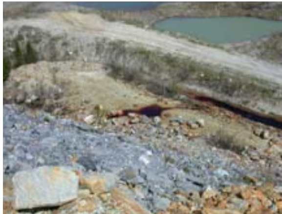
Figure 2. Exemples de DMA. Photo de gauche : Exfiltration au bas d'une halde de stériles générateurs de DMA, Abitibi. Photo de droite : DMA (pH=2.94) au site de l'ancienne mine Eustis, cantons de l'Est.
